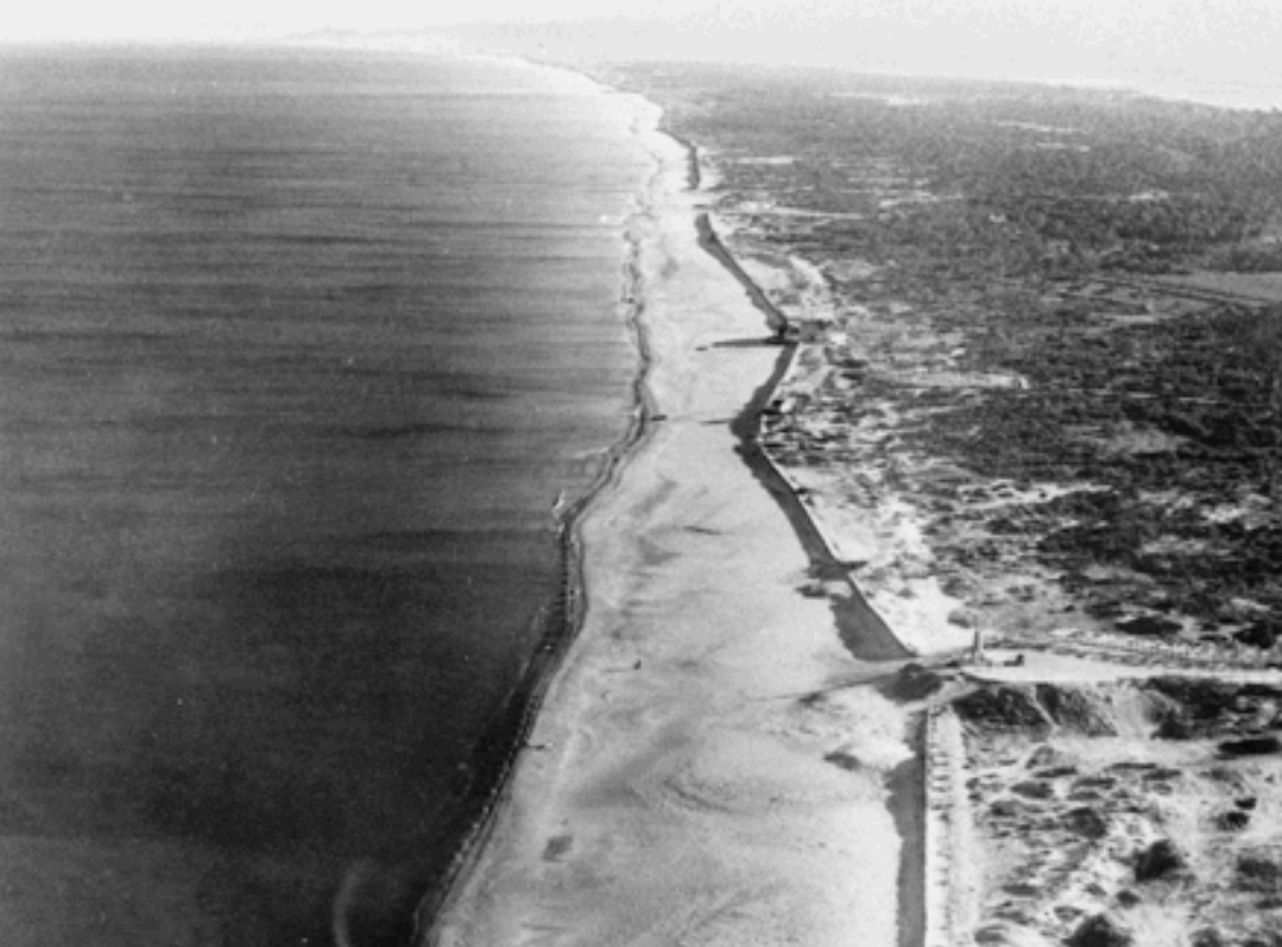
Zona de la Creu antes de la urbanización. Puede observarse la utilización de empalizadas de caña para fijar el primer cordón dunar.
